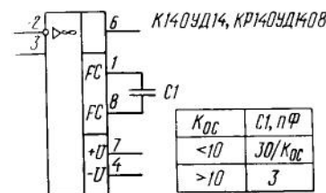
Типовая схема включения ОУ K140УД14, КР140УД1408
